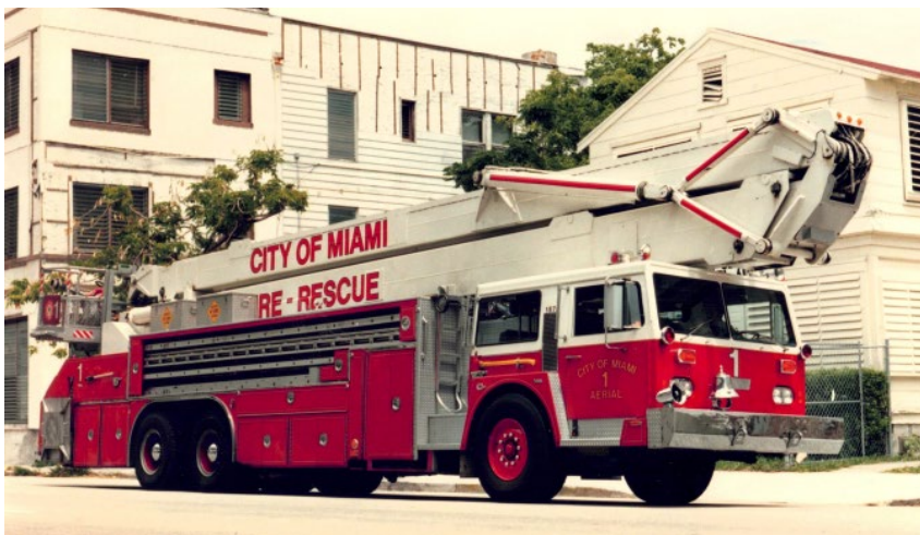
“FireBird” 150-hoogwerker op Hendricksonchassis met 45 meter lange schaararm uit 1978 in dienst bij de brandweer van de stad Miami in Florida
