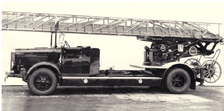
De eerste stalen autoladder op een Magirus M50L-chassis in 1931 gepresenteerd op het autosalon van Berlijn. Deze ladder was al 38,40 m hoog en was voor korte tijd de hoogste autoladder ter wereld. (Foto: Archief SAPP vzw – Fonds Magirus)
