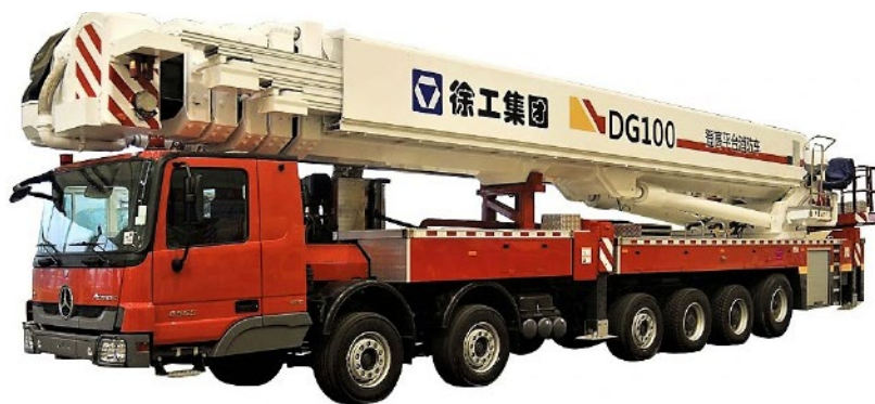
Chinese hoogwerker gefabriceerd door XCMG uitgerust met een 100 meter lange DG100-arm gemonteerd op een 6-assig Mercedes-Benz Actros 6555 12x4-chassis met een totaal grondgewicht van meer dan 64 ton. Dit type machine kan niet zomaar door iedereen worden bediend (Foto: Archief SAPP vzw – CSC Truck Ltd)
