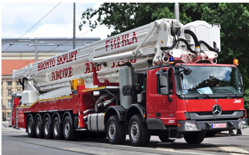
Deze hoogwerker behaalde het wereldhoogterecord in 2010 voor een hulpdienstvoertuig van Bronto Skylift. Dit is een model van 112 meter op een 7-assig Mercedes-Benz 7880 14x6-chassis
