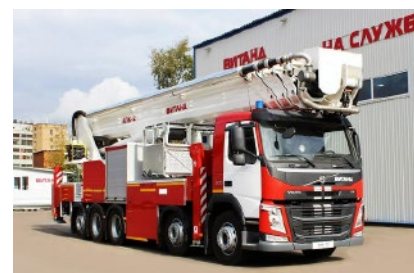
72 meter hoge BITANA-hoogwerker op een 5-assig Volvo FM500-chassis in dienst bij de brandweer van Moskou
