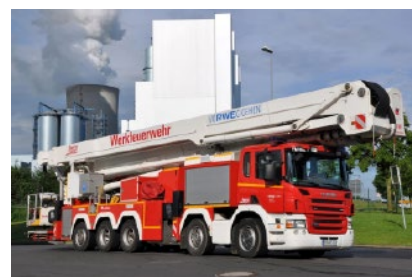
90 meter hoge Bronto Skylift F90HLA op een 5-assig Scania P420-onderstel in gebruik bij de chemische fabriek "Vorweg Gehen" in Duitsland.
