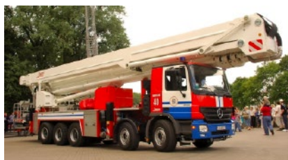
90 meter hoge telescopische Bronto Skylift F90HLA-schaarhoogwerkers, gemonteerd op een 5-assig Mercedes Actros 4150-chassis voor de brandweer van Minsk in Wit-Rusland
