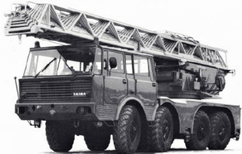
44 meter hoge Magirus-autoladder op een 22-tons Tatra 813 8x8-chassis geleverd aan Praag in 1972 (Foto: Archief SAPP vzw – Fonds Magirus)
